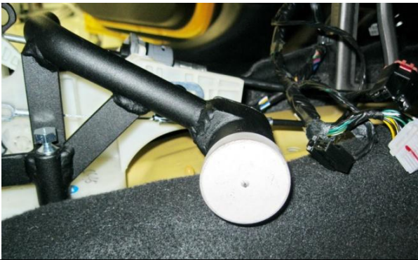
Разметить, используя разметочный шаблон, отверстие в консоли под корпус замка
