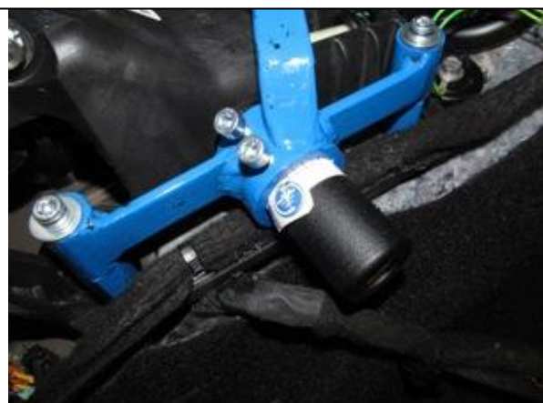
Перевести рычаг переключения передач в положение «R», произвести блокировку, отрегулировать положение хомута на тяге и выход прямоходного цилиндра из кронштейна замка, сорвать винты
