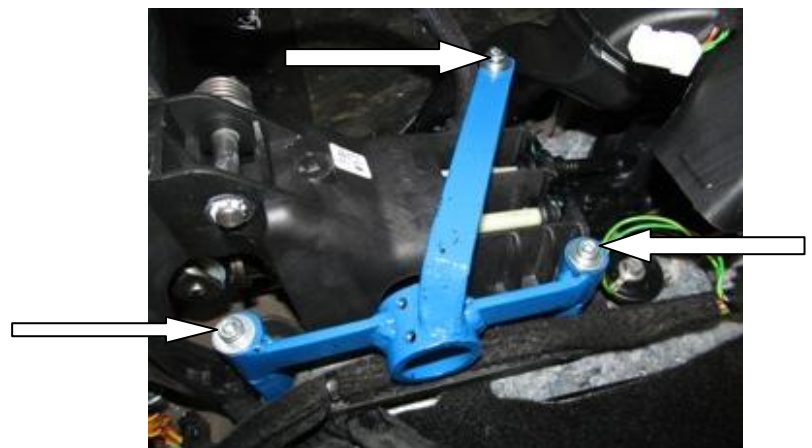
Повторно установить кронштейн на столбики, зафиксировать срывными
