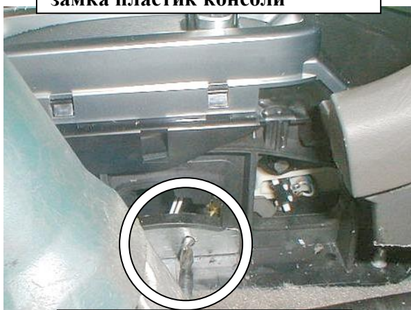
Просверлить отверстие в селекторе под трубу замка
