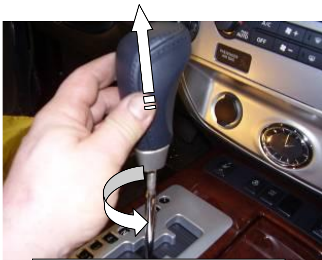
Открутить и снять рукоятку рычага переключения передач
