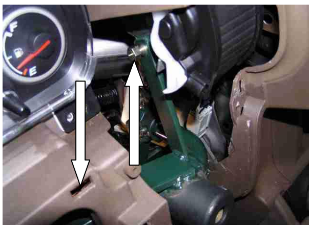
Открутить 2 штатных болта, установить замок, закрутить 2 срывных болта, перевести рычаг переключения передач в положение «Р», произвести блокировку, отрегулировать положение хомута на тяге, зафиксировать винтом
