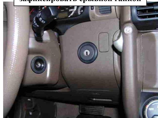
Разметить, используя разметочный шаблон, просверлить и расширить отверстие в передней крышке под корпус замка, установить переднюю крышку на место
