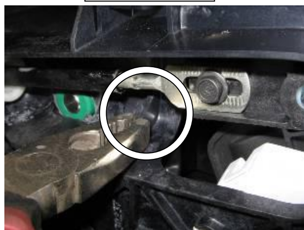
Удалить мешающее хомуту ребро жёсткости 21
