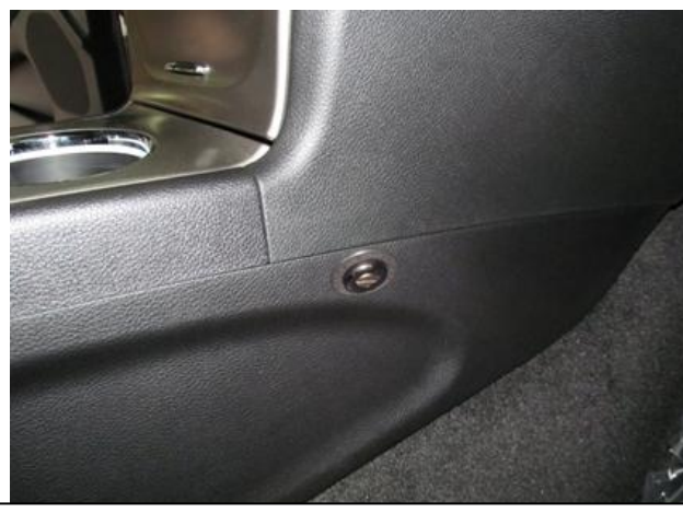
Разметить, используя разметочный шаблон, и просверлить отверстие в консоли под корпус замка, установить консоль на место 24
