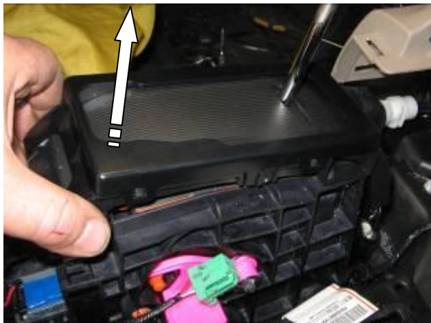
Снять верхнюю крышку селектора
