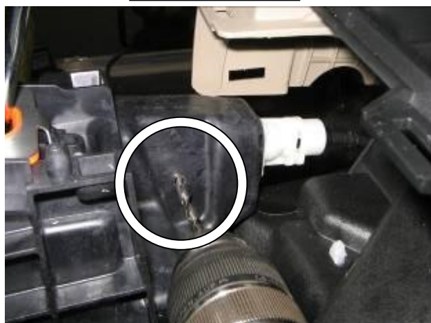
Просверлить отверстие в селекторе под трубу замка
