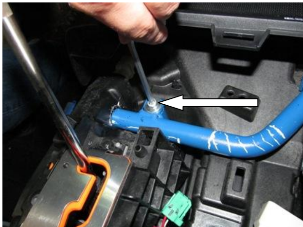
Установить замок на столбик, закрутить болт 19
