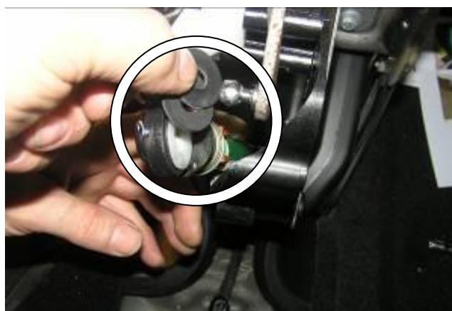
Снять тягу, подложить 2 мягких шайбы
