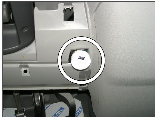
Установить бардачок на место, разметить, используя разметочный шаблон, отверстие под корпус замка
