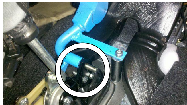
Проверить блокировку, разметить в консоли отверстие под корпус замка, используя разметочный шаблон, просверлить отверстие, установить консоль на место
