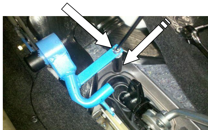
Установить столбик 70 мм., установить замок, закрутить болт
