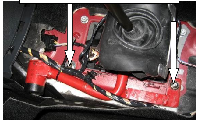
Установить замок трубой в селектор, перевести рычаг переключения передач в положение «Р», произвести и проверить блокировку рычага, закрутить 2 срывных болта
