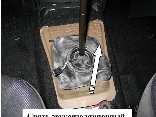
Снять звукоизоляционный кожух селектора
