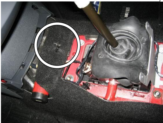
Вернуть ковролин на место, соединить края ковролина пластиковой стяжкой
