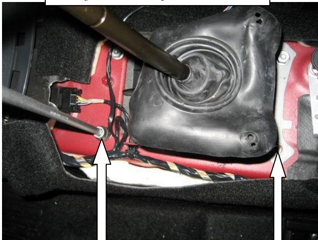
Открутить 2 штатных болта селектора
