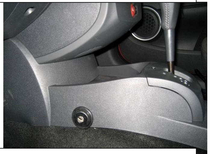
Разметить, используя разметочный шаблон, просверлить и расширить отверстие под корпус замка, установить консоль на место
