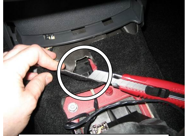
Разрезать и отвернуть ковролин
