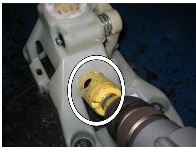
Удалить часть селектора, мешающую установке хомута
