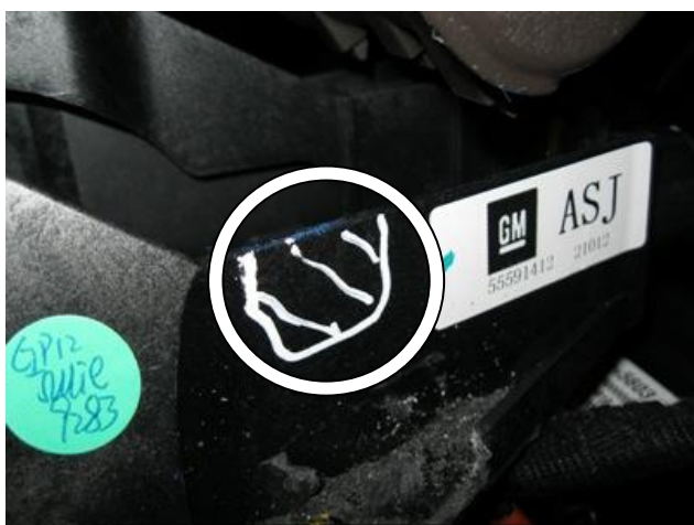
Удалить пластик селектора, мешающий установке замка
