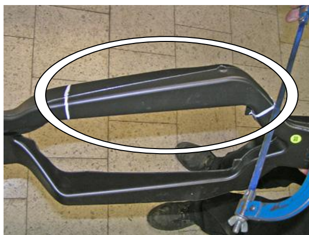
Удалить мешающий пластик воздуховода
