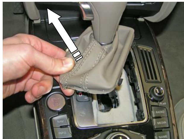
Снять декоративный кожух
