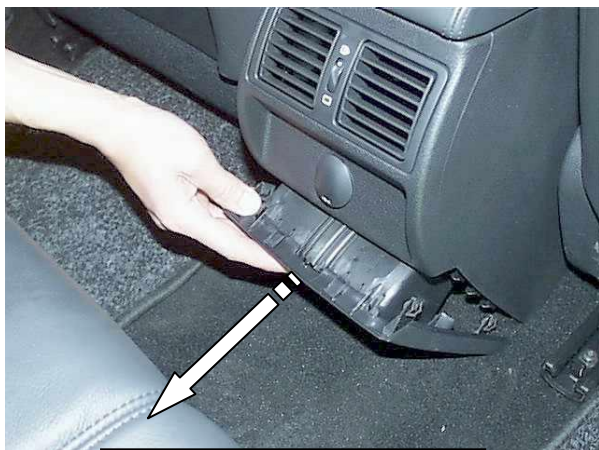
Снять заднюю крышку
