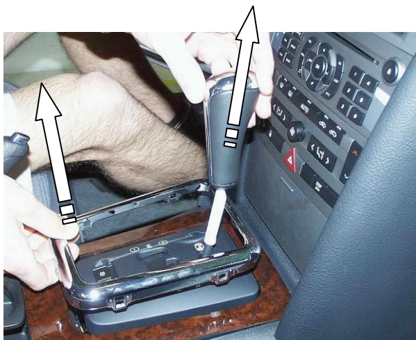
Снять декоративную планку и рукоятку рычага переключения передач
