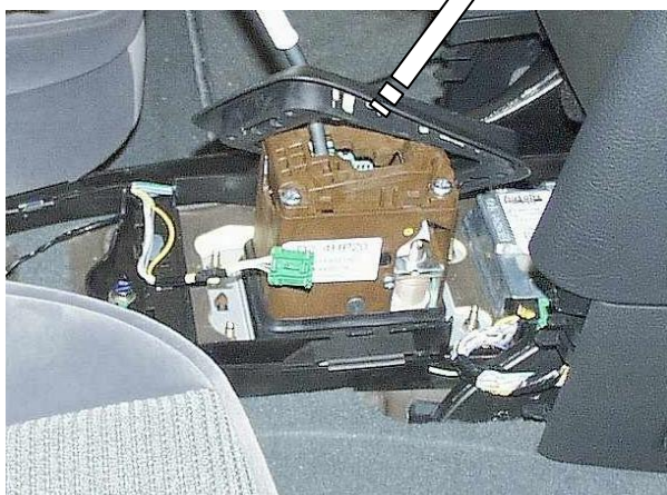
Снять крышку селектора
