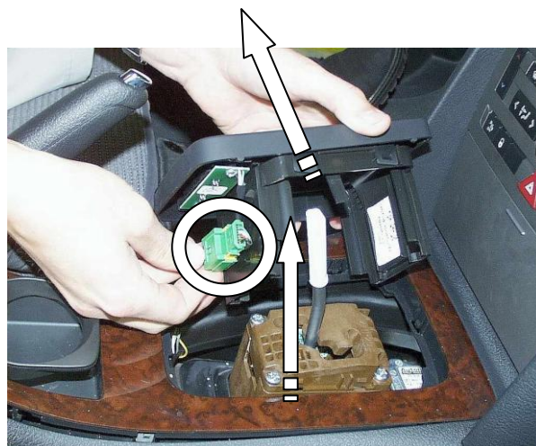
Разъединить разъём, снять верхнюю крышку и верхнюю панель
