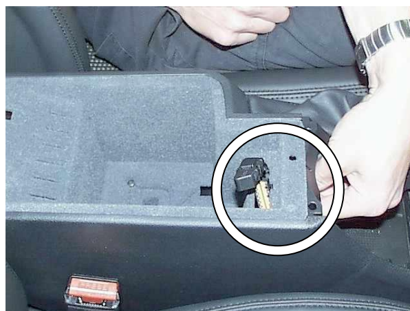
Поднять подлокотник, разъединить разъём
