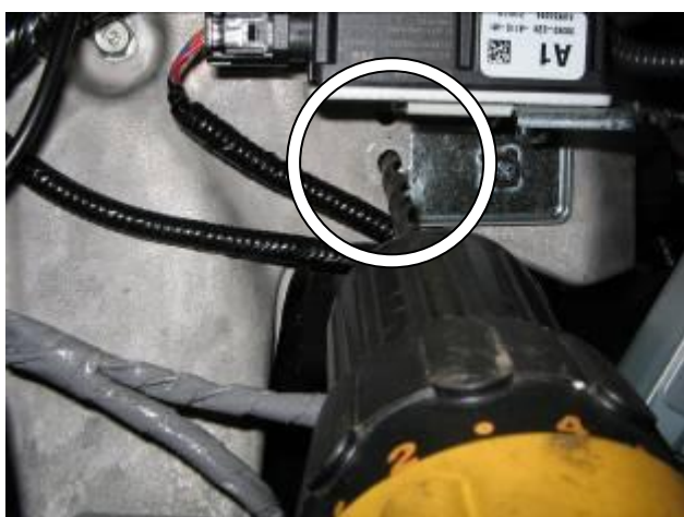
Рассверлить отверстие сверлом 7 мм.
