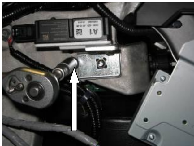
Заменить штатную гайку на срывную
