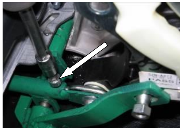
Перевести рычаг переключения передач в положение «R», отрегулировать положение хомута на тяге, зафиксировать хомут винтом
