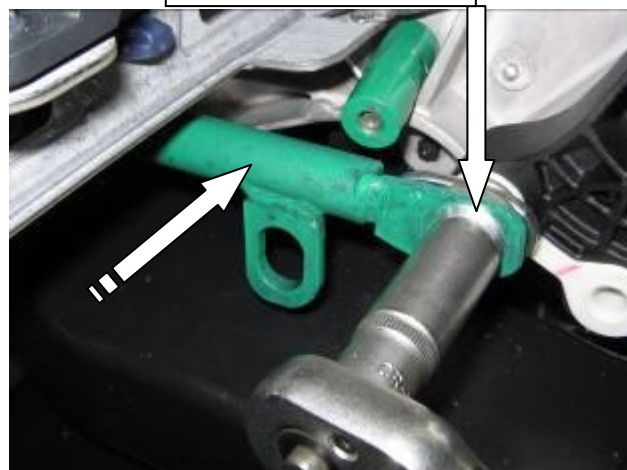
Установить хомут на тягу, зафиксировать срывной гайкой
