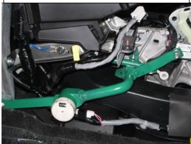
Разметить, используя разметочный шаблон, просверлить и расширить отверстие в консоли под корпус замка
