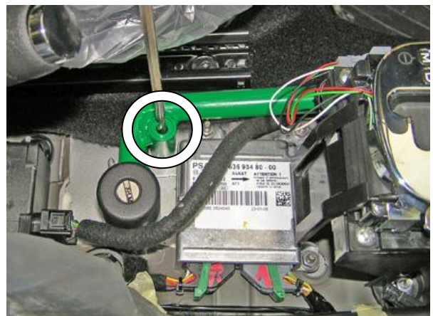
Просверлить крепёжное отверстие в селекторе сквозь отверстие в столбике замка
