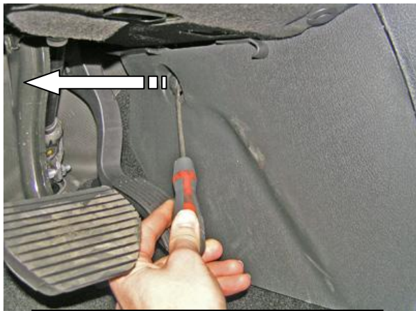
Вынуть клипсы, снять боковые крышки с обеих сторон
