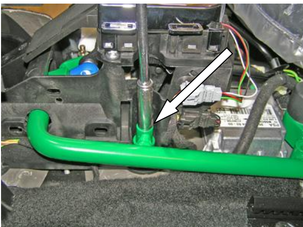
Установить замок на столбик трубой в отверстие, зафиксировать срывным болтом (не срывать!!!)
