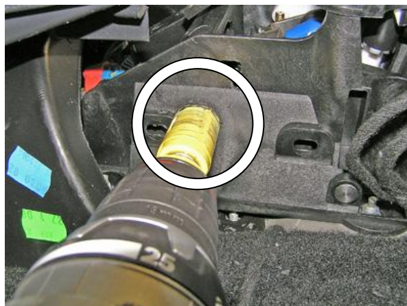
Просверлить отверстие в селекторе под трубу замка
