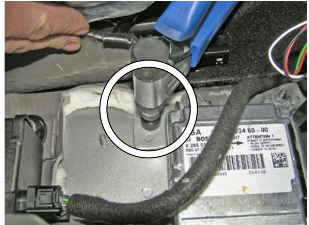
Установить резьбовую заклёпку в отверстие с помощью клёпальника
