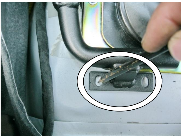
Разметить точки крепления замка
