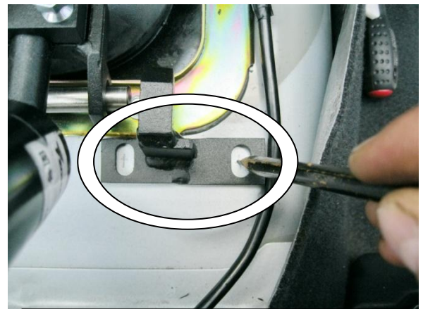
Разметить точки крепления замка
