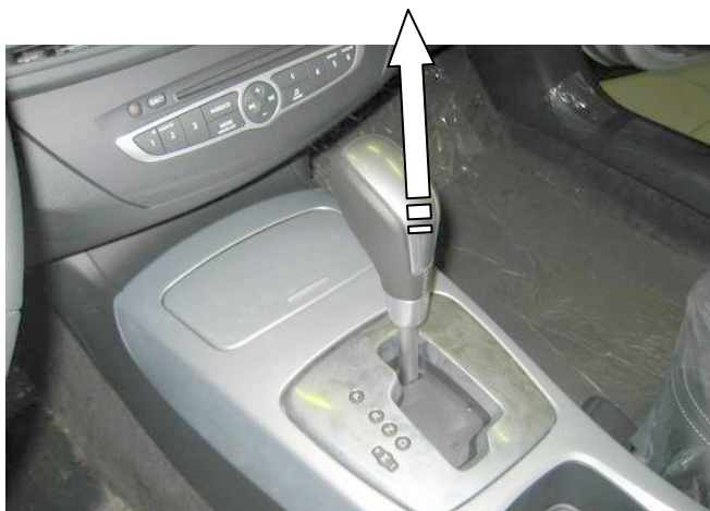
Снять рукоятку рычага переключения передач
