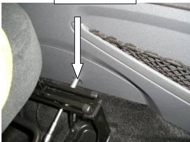
Сдвинуть переднее кресло до упора вперёд, открутить саморез
