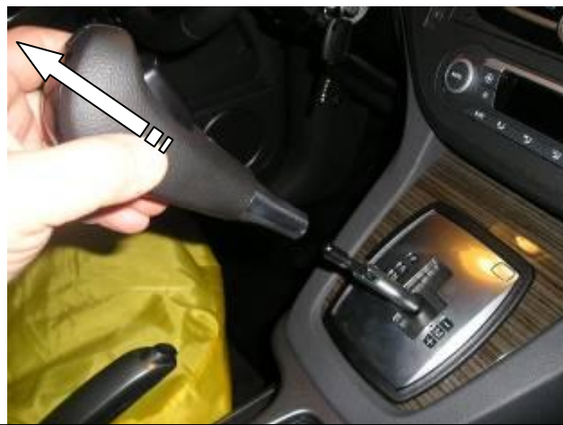
Снять рукоятку рычага переключения передач
