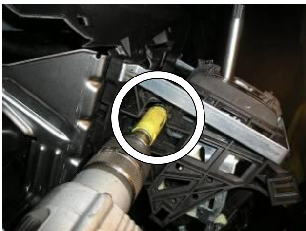
Просверлить отверстие в селекторе под трубу замка
