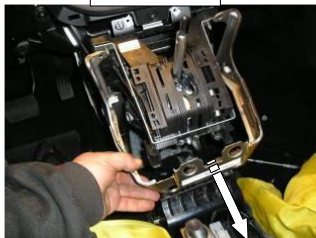
Снять держатель консоли
