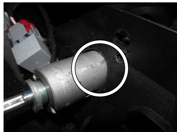
Снять замок, просверлить отверстие 22 мм. в стенке селектора под трубу замка
