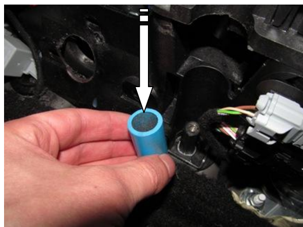
Установить на столбик защиту
