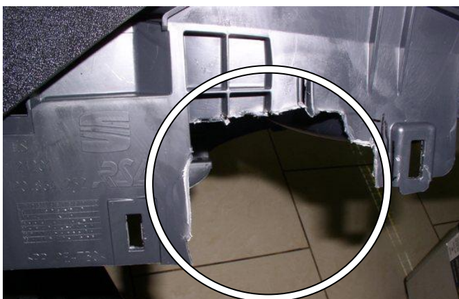
Удалить пластик консоли, мешающий установке замка, вернуть консоль на место
